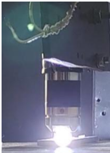
Рисунок 3 – Процесс плазменной сварки на разработанном плазмотроне.
